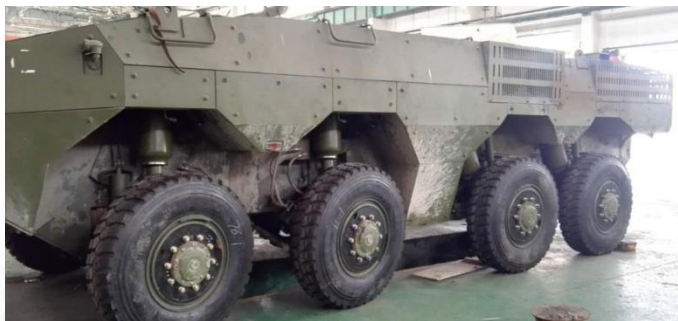
617厂军车搭载安路普空气悬架系统
