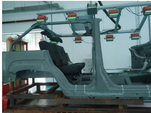
后面碰撞: 试验照片
