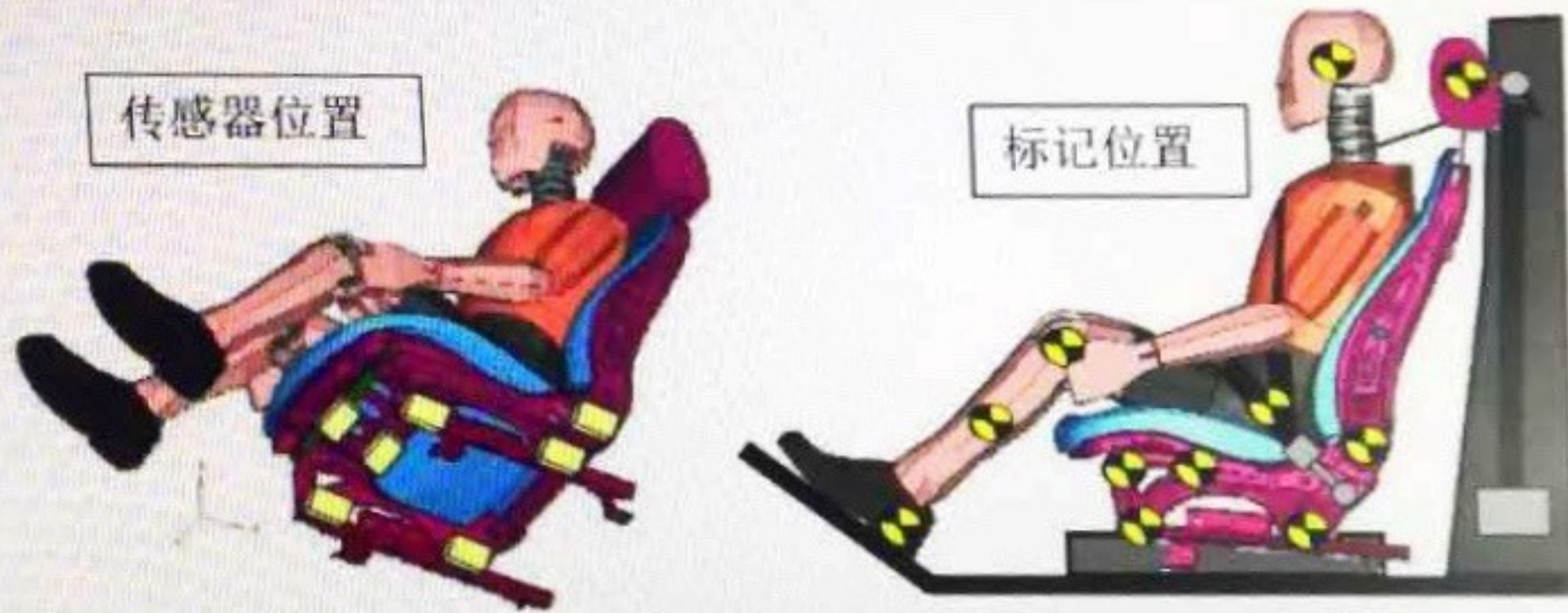
图 12 台车动态冲击试验传感器位置和标记位置
