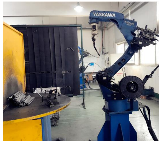
焊接机器人 Welding robot
