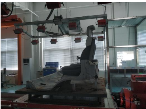
后面碰撞 b: 试验照片
