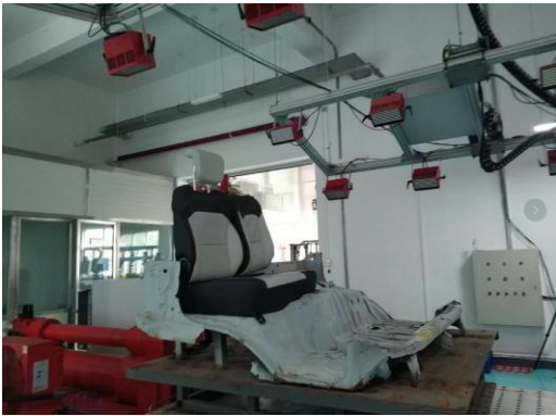
后面碰撞：试验照片
