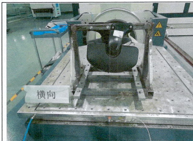
图 1-5 横向冲击安装图
