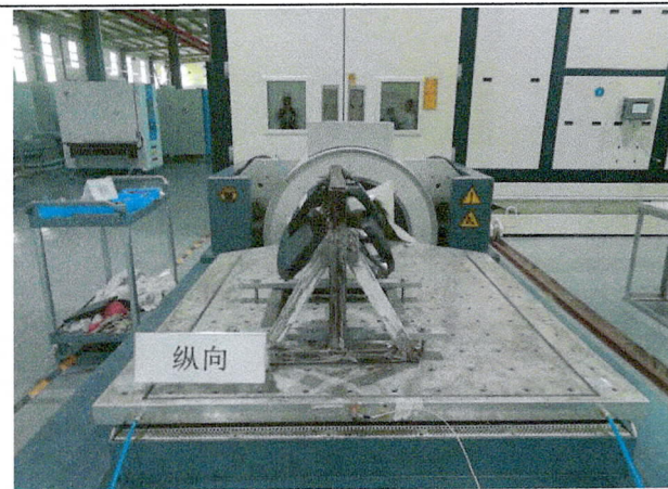
图 1-8 纵向冲击安装图
