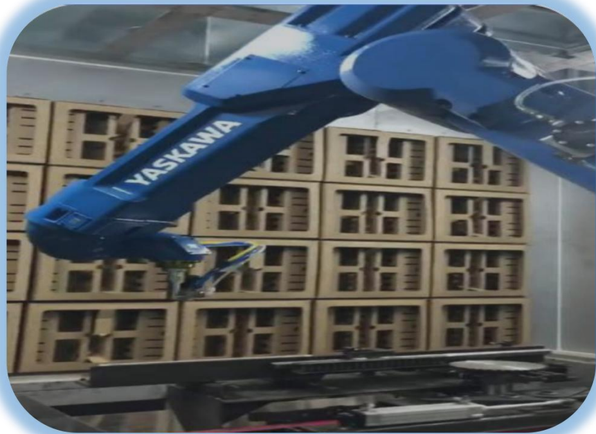
积放线采用防爆式6轴机器人喷漆展示
