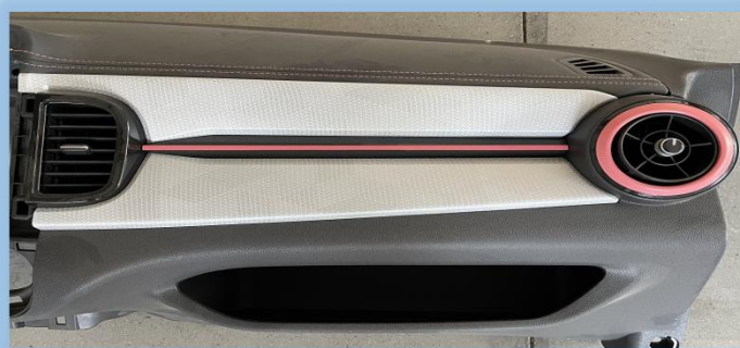
右侧装饰面板高光喷漆+烫印
