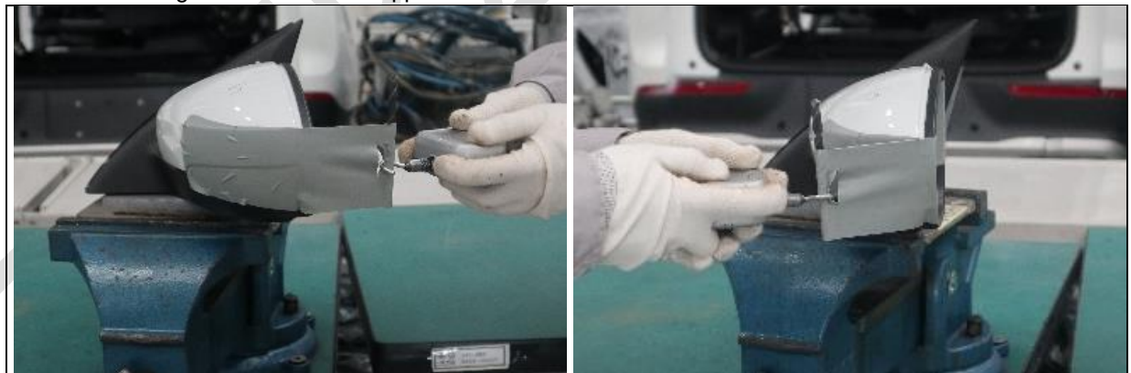
Abb.2: Messung der An- und Abklappkräfte 外后视镜折叠力测量
