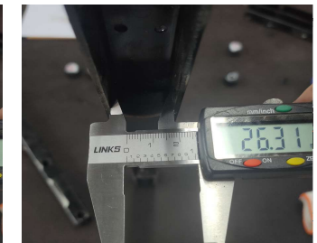
上框右侧支架滚轮运动区域前中后测量三次
