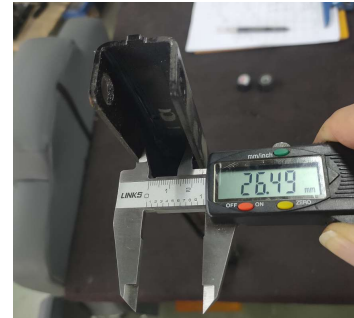
上框左侧支架滚轮运动区域前中后测量三次
