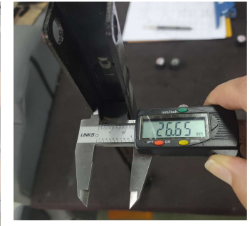
上框左侧支架滚轮运动区域前中后测量三次
