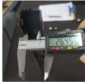
上框左侧支架滚轮运动区域前中后测量三次
