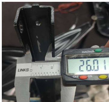
下框左侧支架滚轮运动区域前中后测量三次
