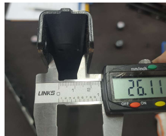
上框右侧支架滚轮运动区域前中后测量三次
