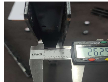
上框右侧支架滚轮运动区域前中后测量三次
