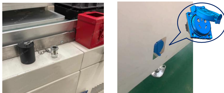
图4 压缩空气接口安装及线体插座图示
